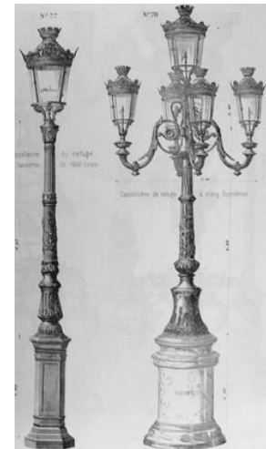
Lanternes à gaz montées sur des candélabres en fonte
