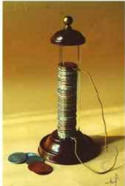
Première pile inventée par Mr Volta- 1800
