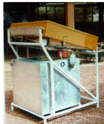
Premier réfrigérateur solaire à adsorption entièrement fabriqué au Burkina Faso http://www.habiter-autrement.org
